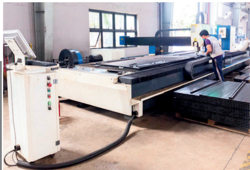
LASER - FIBER MACHINE 2 FUNCTION ( CUTTING TUBESS AND SHEETS ) MÁY LASER - FIBER 2 CHỨC NĂNG CẮT ỐNG VÀ TẤM
